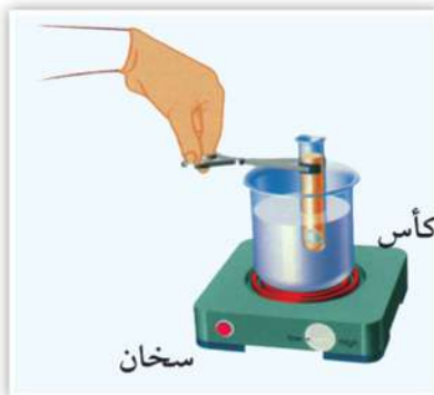
شكل (٣٨): تبخر الماء بالحرارة وترك الملح في الكأس.
